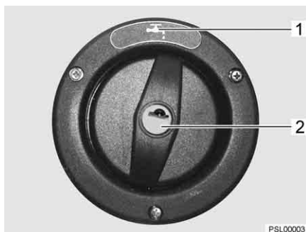
Bild 188 Påfyllningsöppning för dricksvatten
