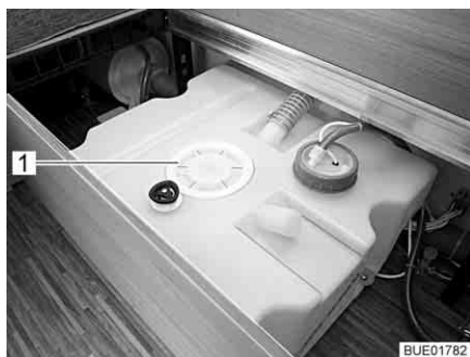
Bild 207 Rengöringsöppning vattentank (exempel)
