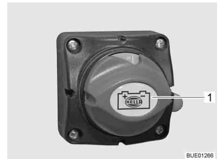
Bild 119 Batteri-huvudbrytare, läge "TILL"
