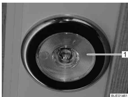
Fig. 48 Lampe encastrée, interrupteur d'éclairage dans la lampe
