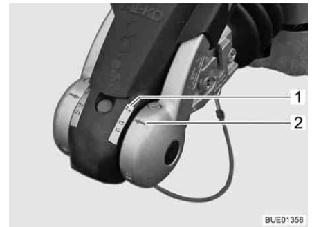
Fig. 7 Contrôle "AKS terminé"
