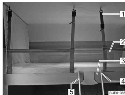
Fig. 89 Lit escamotable avec filet de sécurité tendu
