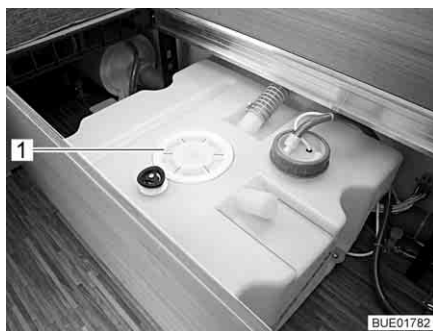
Fig. 194 Ouverture de nettoyage du réservoir d'eau
