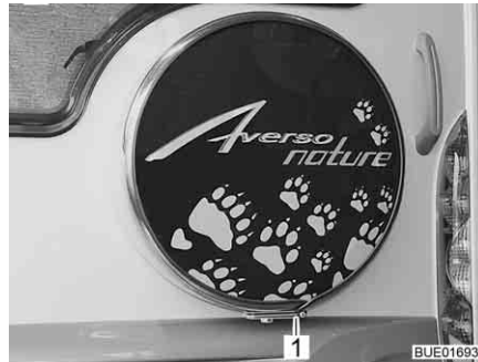
Fig. 224 Étrier de roue de secours à l'arrière du véhicule
