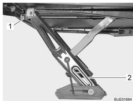
Fig. 24 Stabilisateur avec plaque d'embase (abaissé)
