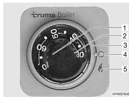
Fig. 151 Unité de commande pour le chauffe-eau Truma (régime au gaz)
