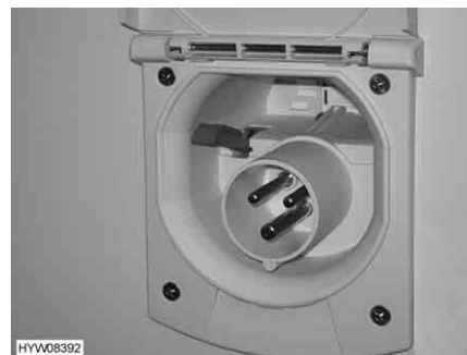
Fig. 121 Raccordement 230 V sur le véhicule
