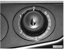
Fig. 135 Hot-air heater control knob
