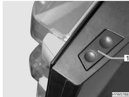
Fig. 173 Tasto di sblocco della porta del frigorifero (serie Dometic 8)
