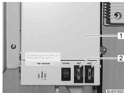
Fig. 130 Regolatore riscaldamento per tubazioni delle acque grigie
