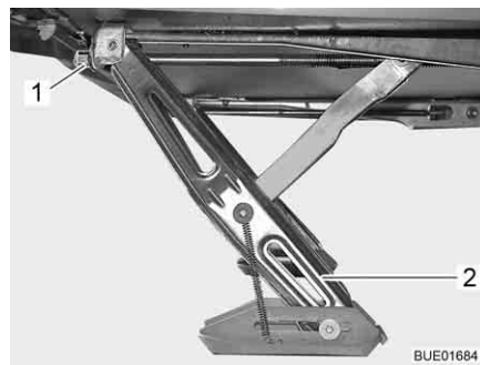
Fig. 24 Piedino di stazionamento a manovella con piastra del piede (abbassato)
