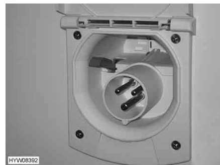
Fig. 126 Collegamento a 230 V sul veicolo
