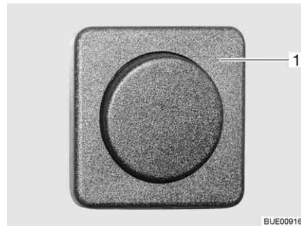
Fig. 47 Luci interne, interruttori luci staccati dalla lampada
