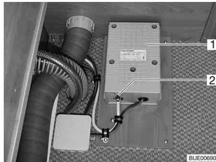
Fig. 148 Transformador para calentamiento eléctrico del piso
