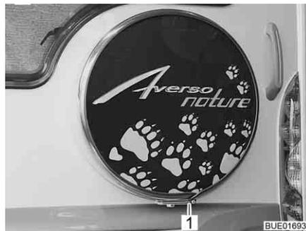
Fig. 230 Soporte para rueda de repuesto en la parte trasera del vehículo
