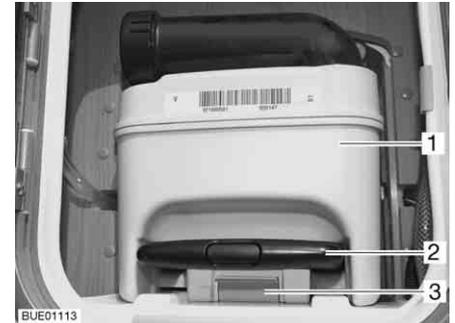
Fig. 188 Depósito de aguas fecales
