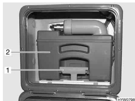
Fig. 198 Depósito de aguas fecales
