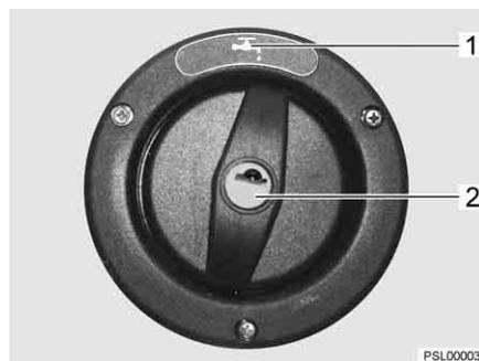
Fig. 181 Tubo de llenado de agua potable
