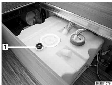
Fig. 182 Depósito de agua
