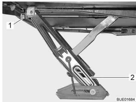
Fig. 24 Stabilisateur avec plaque d'embase (abaissé)
