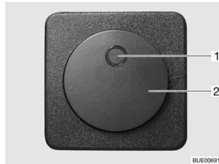
Fig. 149 Commutateur du chauffage électrique du plancher
