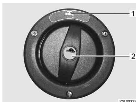
Fig. 181 Bec de remplissage d'eau potable
