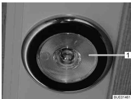
Fig. 48 Lampe encastrée, interrupteur d'éclairage dans la lampe
