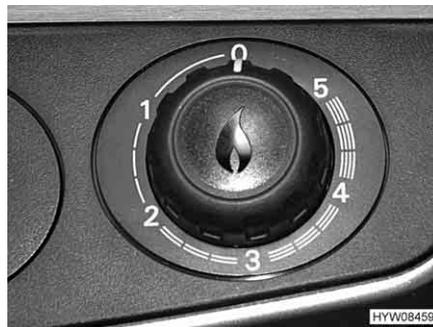
Fig. 140 Bouton tournant du chauffage à air chaud
