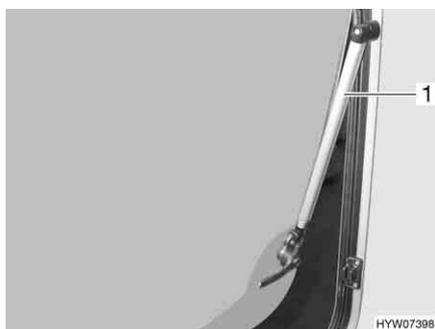
Fig. 64 Fenêtre projetante avec bras automatiques
