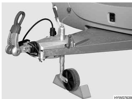
Fig. 223 Bloquer la roue d'appui
