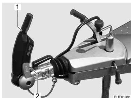
Fig. 203 Indicateur garnitures de friction avant et arrière
