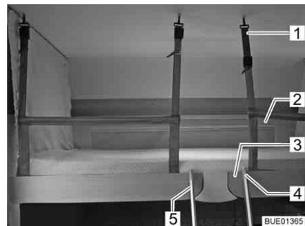
Bild 83 Hubbett mit aufgespanntem Sicherungsnetz
