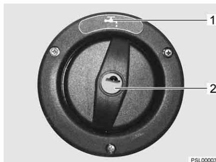
Bild 181 Trinkwasser-Einfüllstutzen
