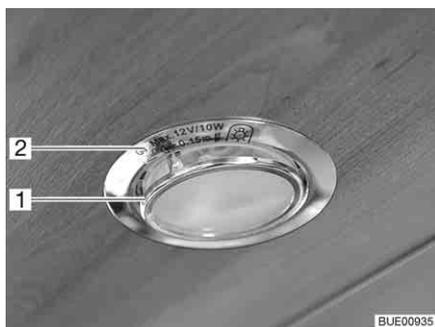
Bild 233 Halogeneinbauleuchte (flach)
