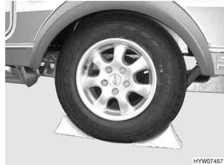
Bild 248 Fahrzeug sichern
