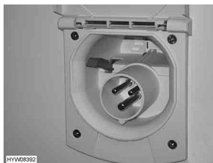
Bild 122 230-V-Anschluss am Fahrzeug
