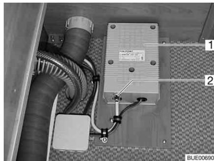
Bild 148 Trafo für elektrische Fußbodenerwärmung
