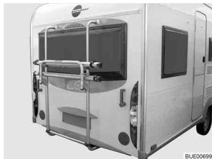
Bild 12 Fahrradträger an Heckwand
