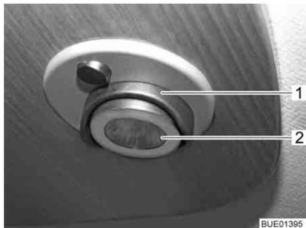
Bild 232 Halogeneinbauleuchte
