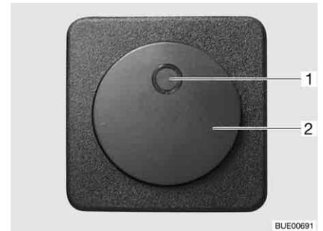
Fig. 149 Interruptor para calentamiento eléctrico del piso
