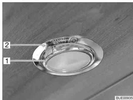
Fig. 233 Lámpara halógena empotrada (plana)
