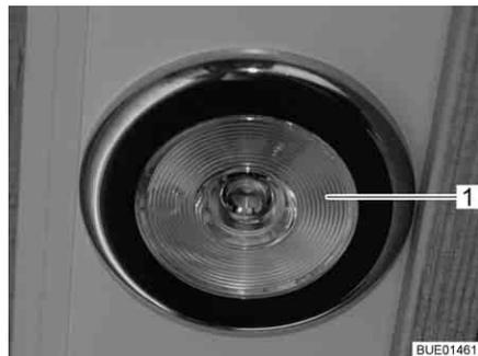
Fig. 44 Lámpara empotrada, interruptor de luz dentro de la lámpara
