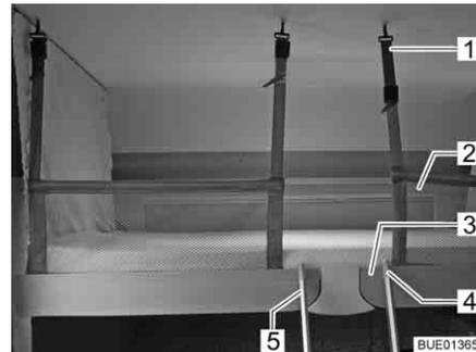
Fig. 83 Cama elevada con red de seguridad tendida
