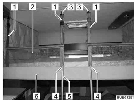
Fig. 85 Cama elevada con red de seguridad tendida
