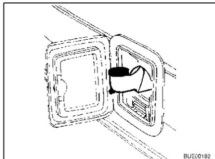
Fig. 203 Tubo de llenado de agua potable, girado hacia fuera
