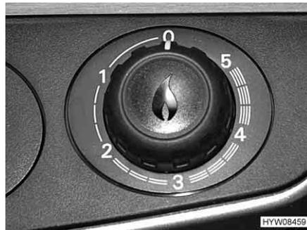
Fig. 140 Regulador giratorio en la calefacción de aire caliente
