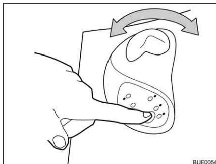
Fig. 219 Vaciar el depósito de agua
