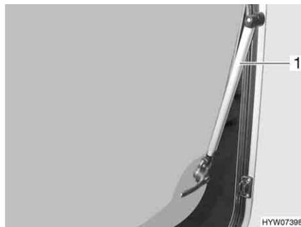
Fig. 60 Ventana abatible con soporte automático
