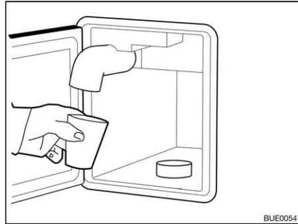
Fig. 220 Vaciar el tubo de llenado de agua potable
