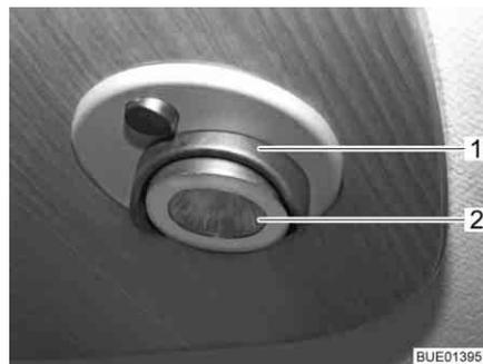
Fig. 232 Lámpara halógena empotrada
