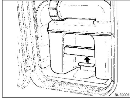
Fig. 206 Tirar del estribo de sujeción
