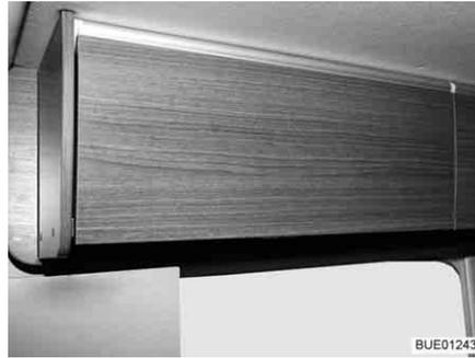
Fig. 39 Trampillas de muebles con desbloqueo por presión (ejemplo)
