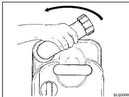
Fig. 189 Girar el tubo de vaciado
