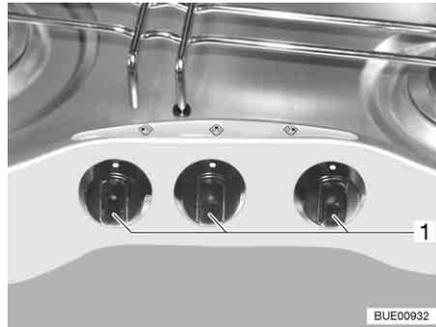
Fig. 161 Elementos de mando para la cocina de gas
