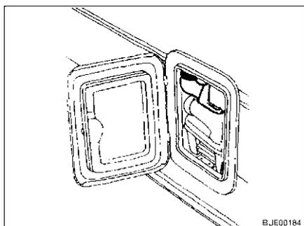
Fig. 205 Tubo de llenado de agua potable, girado hacia dentro
