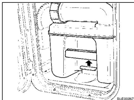
Fig. 187 Tirar del estribo de sujeción
