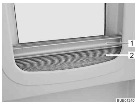
Fig. 27 Dispositif occultant plissé
