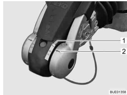
Fig. 4 Controllo "AKS chiuso"
