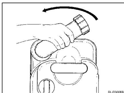
Fig. 172 Ruotare il bocchettone di scarico
