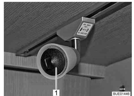
Fig. 225 Ventosa per la sostituzione delle lampade
