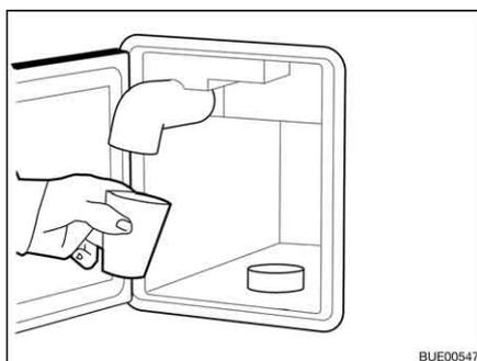
Fig. 203 Svuotare il bocchettone di riempimento dell'acqua potabile
