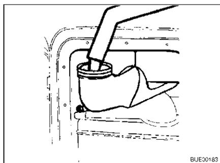
Fig. 187 Rifornimento d'acqua potabile
