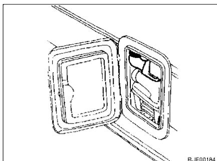
Fig. 188 Bocchettone di riempimento dell'acqua potabile, ruotato verso l'interno
