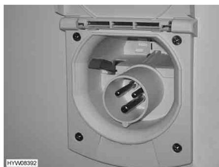
Fig. 110 Collegamento a 230 V sul veicolo
