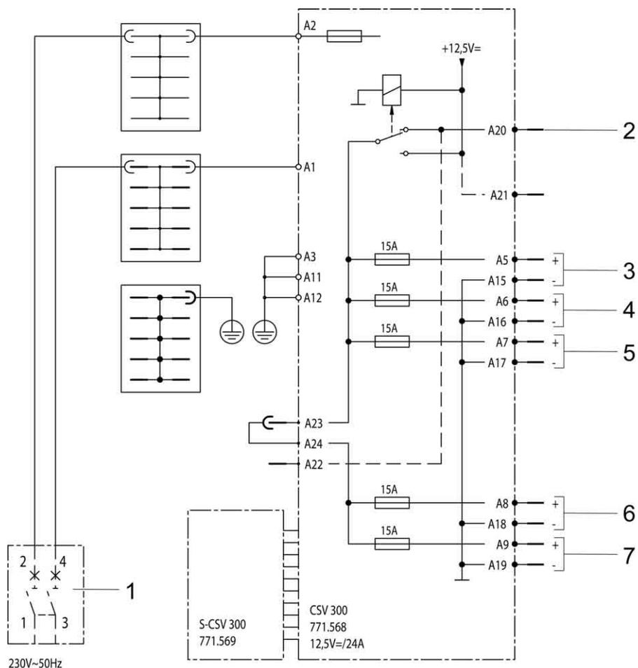
Fig. 119 Schema elettrico interno (CSV 300)
