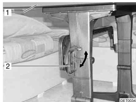
Fig. 71 Tavolo orientabile con telaio di plastica
