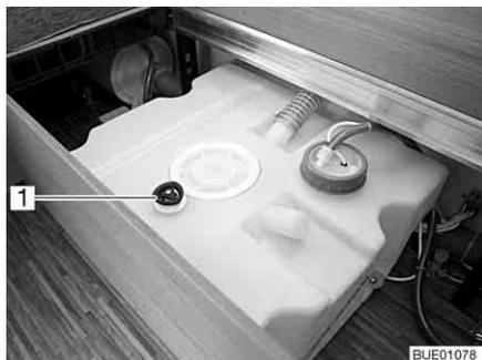
Fig. 165 Serbatoio dell'acqua
