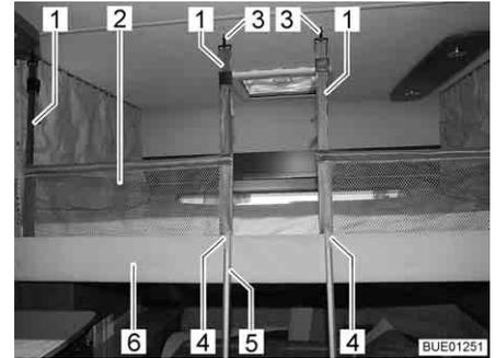
Fig. 79 Letto basculante con rete protettiva montata
