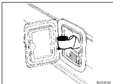
Fig. 186 Bocchettone di riempimento dell'acqua potabile, ruotato verso l'esterno
