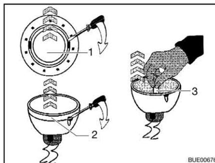
Fig. 216 Sostituire la lampada alogena ad incandescenza
