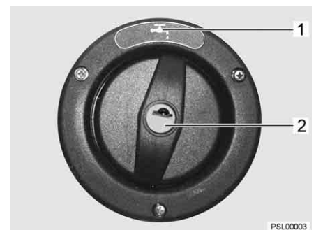
Fig. 147 Bocchettone di riempimento dell'acqua potabile (alternativa)
