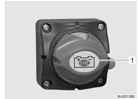
Fig. 89 Interruttore principale batteria, posizione "ON"
