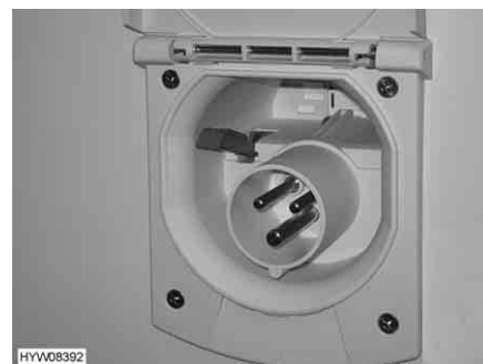
Afb. 95 230-V-aansluiting op het voertuig
