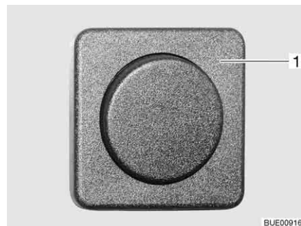
Afb. 42 Binnenverlichting, lichtschakelaar gescheiden van de lamp
