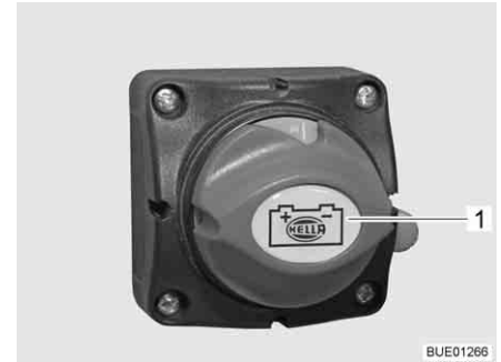
Billede 89 Batterihovedafbryder, stilling "ON"
