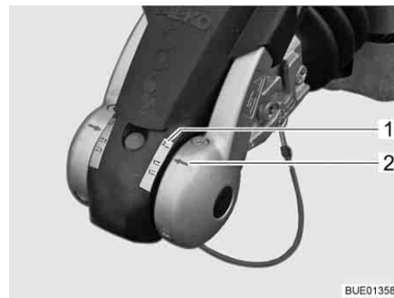
Billede 4 Kontrol "AKS lukket"
