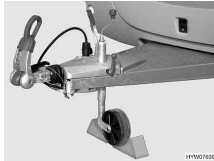
Billede 230 Sikring af støttehjulet
