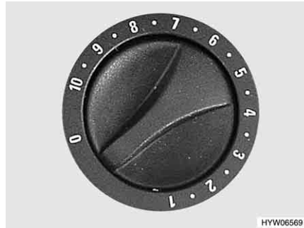
Billede 124 Drejeregulator på varmeovnen
