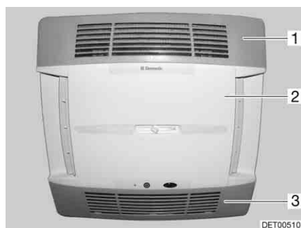
Billede 205 Klimaanlæg (Dometic)
