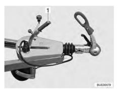
Fig. 17 Handbrake
