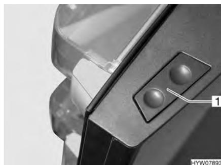
Fig. 146 Botón de desbloqueo de la puerta del frigorífico (Dometic de la serie 8)
