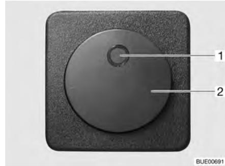
Fig. 124 Interruptor para calentamiento eléctrico del piso
