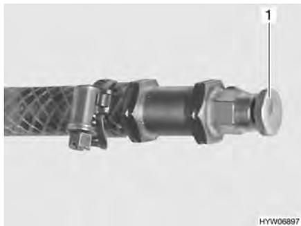
Fig. 200 Válvula de purga de la calefacción de agua caliente
