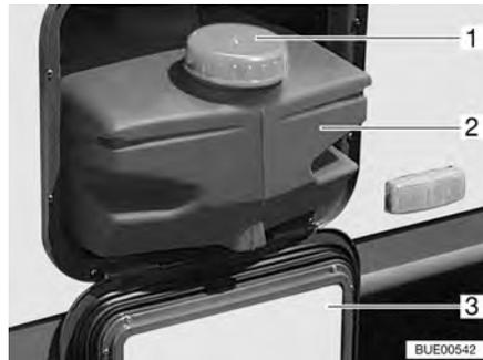
Fig. 150 Depósito de agua 22 l
