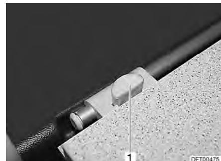
Fig. 69 Bloque del tablero de la mesa (variante)
