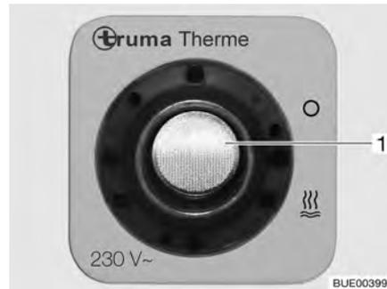
Fig. 129 Conmutador de mando para calentador Therme
