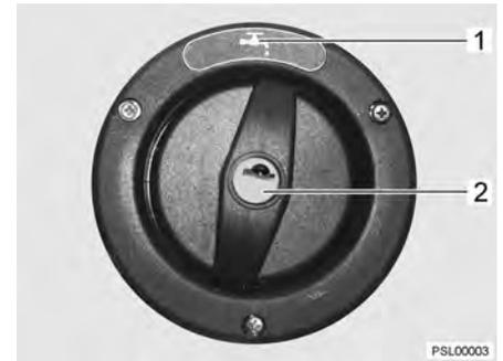
Fig. 152 Tubo de llenado de agua potable (alternativa)
