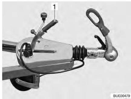
Fig. 17 Handbrake
