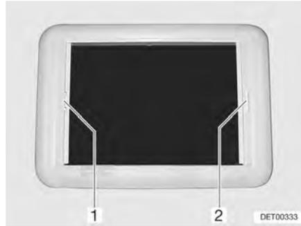
Bild 66 Heki-Dachhaube, Rollo-Verriegelung
