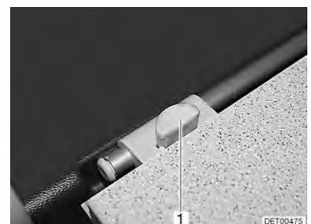
Bild 68 Verriegelung Tischplatte (Variante)
