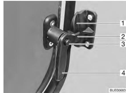
Bild 30 Fenster in der Eingangstür in Stellung "Dauerbelüftung"
