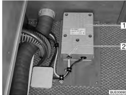
Bild 124 Trafo für elektrische Fußbodenheizung
