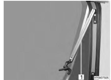
Bild 56 Ausstellfenster mit Automatik-Ausstellern, geöffnet
