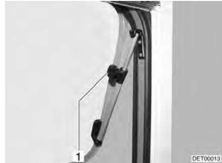
Bild 53 Ausstellfenster mit Dreh-Ausstellern, geöffnet
