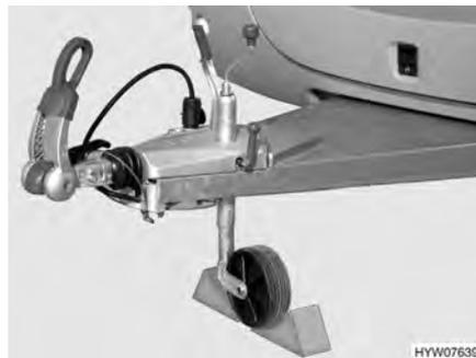
Fig. 218 Bloquer la roue d'appui
