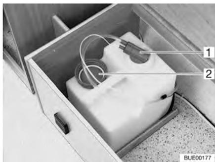
Fig. 152 Réservoir d'eau 16 l
