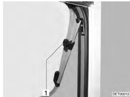
Fig. 53 Fenêtre projetante avec bras pivotants, ouverte
