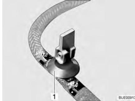
Fig. 159 Robinet de vidange (avec levier à bascule)
