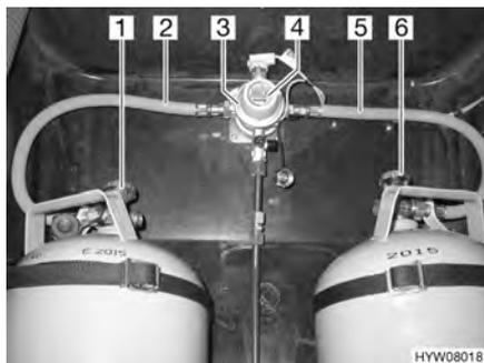
Fig. 98 Dispositif de commutation DuoControl
