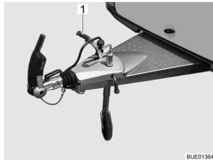
Bild 18 Feststellbremse
