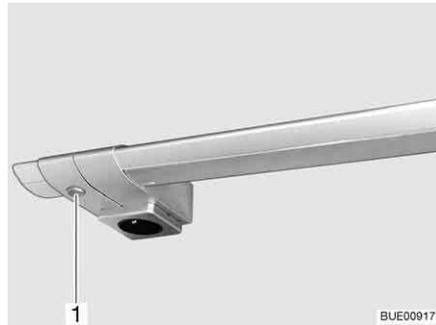
Bild 42 Innenleuchte, Lichtschalter direkt an der Leuchte
