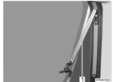
Bild 56 Ausstellfenster mit Automatik-Ausstellern, geöffnet
