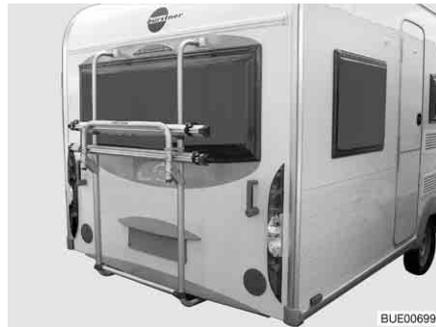
Bild 12 Fahrradträger an Heckwand
