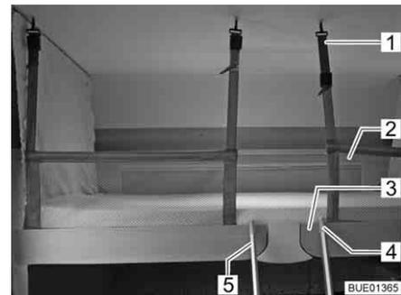
Bild 77 Hubbett mit aufgespanntem Sicherungsnetz
