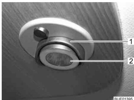
Bild 217 Halogeneinbauleuchte
