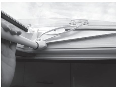
Afb. 117: Dakluik 400x400 mm / VisionStar 700x500 mm bedienen
