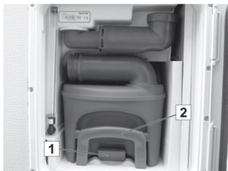
Fig. 140: Toilettank i tømmeskakten
