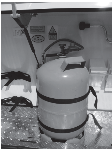
Fig. 75 : Vanne de détendeur
