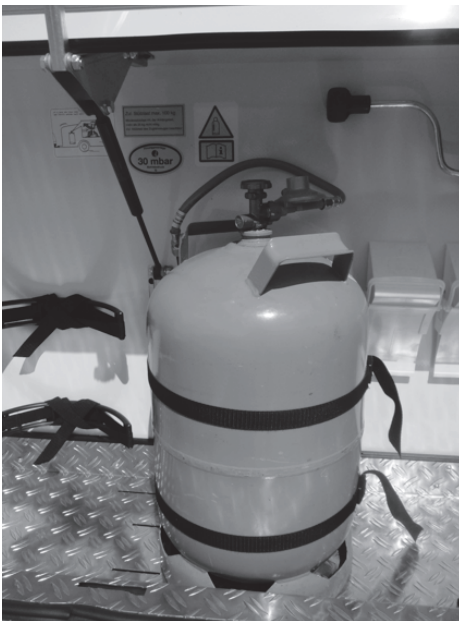
Fig. 74 : Caisson à gaz ouvert
