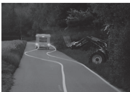
Fig. 9: Système de stabilisation de trajectoire ATC
