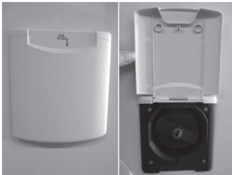
Fig. 27 : Manchon de remplissage d'eau fraîche
