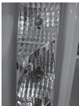
Fig. 165 : Remplacement de l'ampoule
