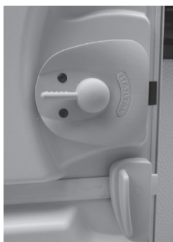
Fig. 20 : Serrure de porte fermée mais non sécurisée
