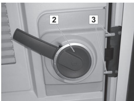
Fig. 15: Dør lukket og sikret
