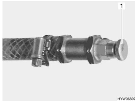
Fig. 287 Soupape de purge pour le chauffage à eau chaude
