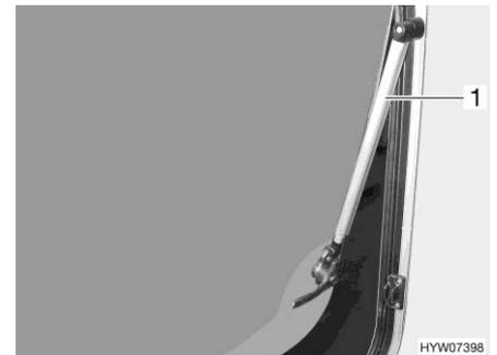
Fig. 99 Fenêtre projetante avec bras automatique
