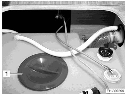
Fig. 283 Ouverture de nettoyage du réservoir d'eau
