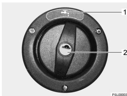
Fig. 248 Bec de remplissage d'eau potable dans la paroi latérale du véhicule
