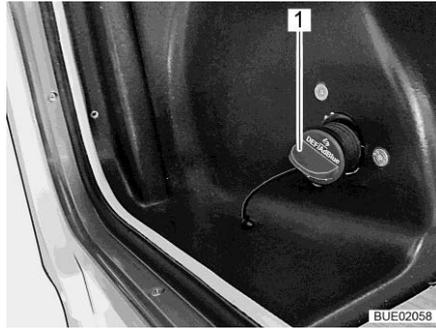
Fig. 44 Bec de remplissage d'AdBlue® (Fiat)
