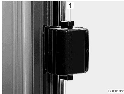
Fig. 102 Fenêtre coulissante, verrouillée
