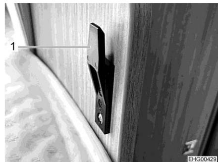
Fig. 177 Fixation pour la protection antichute (pied du lit)
