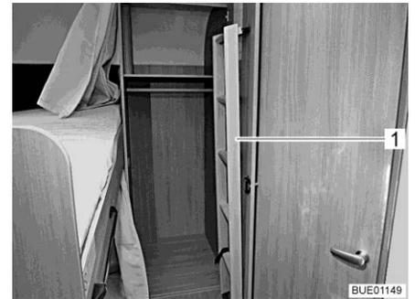
Fig. 14 Échelle de montée dans la penderie
