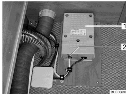
Fig. 224 Transformateur du chauffage électrique du plancher
