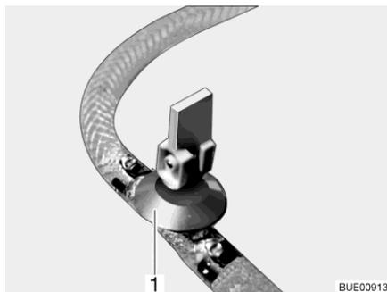
Fig. 258 Robinet de vidange (avec levier à bascule)
