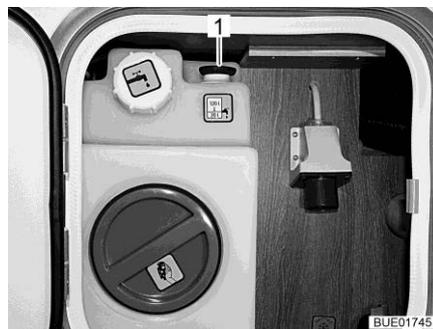
Fig. 254 Réservoir d'eau (unité de service)
