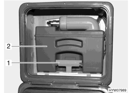
Fig. 269 Réservoir pour matières fécales (exemple)
