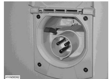
Fig. 195 Raccordement 230 V sur le véhicule (sans unité de service)
