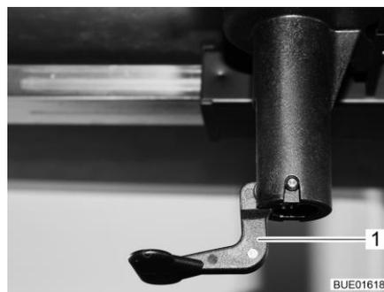
Fig. 124 Dispositif de déverrouillage plateau de table
