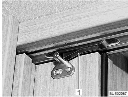
Fig. 17 Cran d'arrêt à ressort
