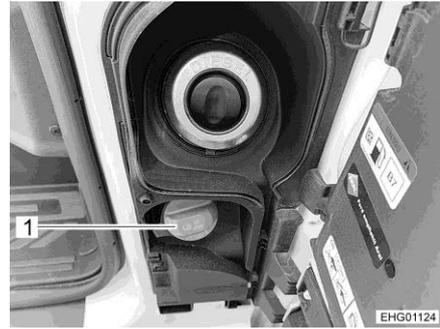
Fig. 45 Bec de remplissage d'AdBlue® (Ford)
