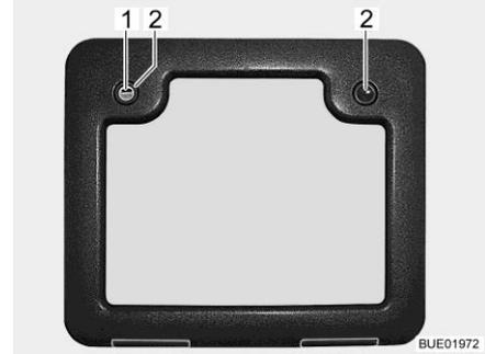
Fig. 63 Verrou de pression du portillon de service (alternative)
