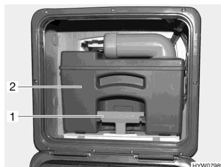
Fig. 281 Réservoir pour matières fécales (exemple)
