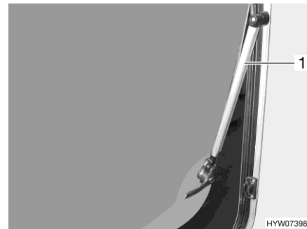
Afb. 99 Uitzetbaar raam met automatische uitzetters
