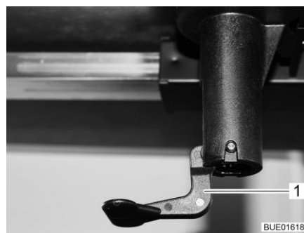
Kuva 124 Pöytälevyn lukituksen avauspainike
