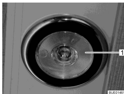
Kuva 79 Uppovalaisin, valokatkaisija valaisimessa
