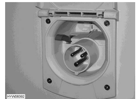
Kuva 195 230 V:n liitäntä ajoneuvossa (ilman huoltoyksikköä)
