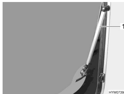
Billede 99 Ventilationsrude med automatiske udskydere
