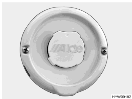
Billede 222 Vægskorsten (varmtvandsvarmeovn)
