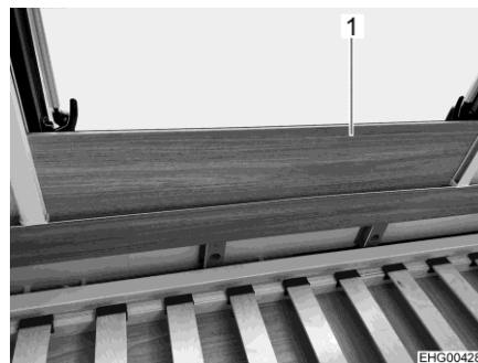
Billede 176 Sikring mod at falde ud (vindue)
