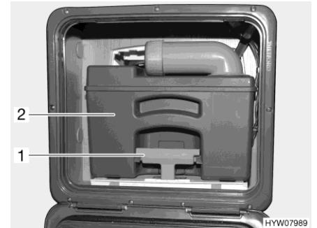
Billede 281 Toilettank (eksempel)
