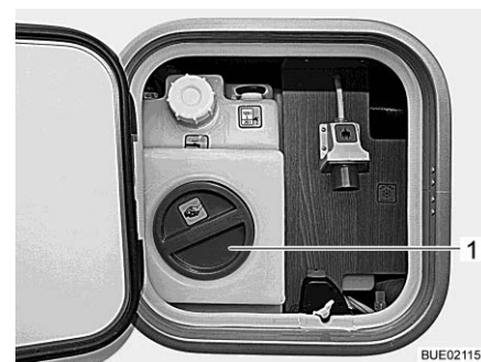
Billede 284 Rengøringsåbning på vandtank (serviceenhed)
