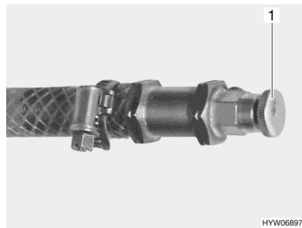
Billede 287 Udluftningsventil varmtvandsvarmeovn
