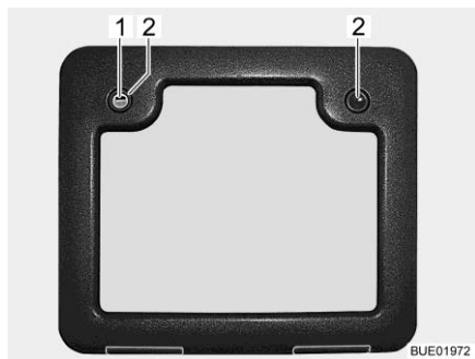
Bild 280 Lucka för latrintanken (alternativ)
