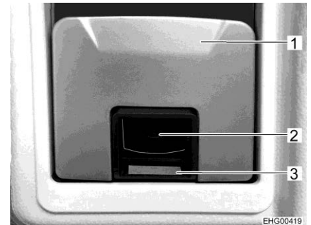
Bild 57 Dörrlås, variant (ingångsdörr insida)
