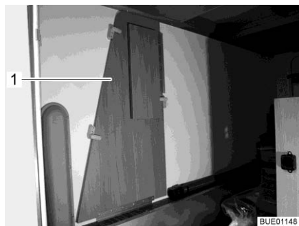
Bild 13 Sängbreddning i det bakre lastutrymmet
