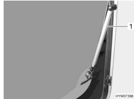
Bild 99 Överkantshängt fönster med automatik-spärr
