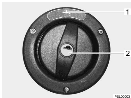
Bild 248 Påfyllningsöppning för dricksvatten i fordonets sidovägg
