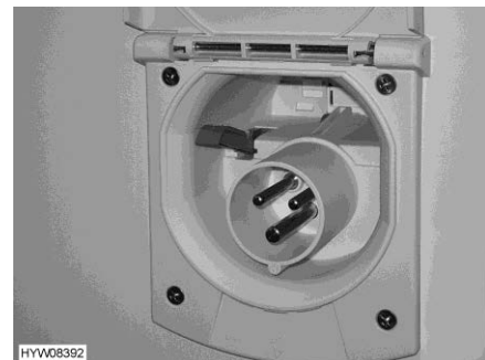
Bild 195 230 V-anslutning på fordonet (utan Service Unit)
