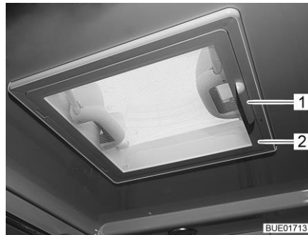
Bild 111 Taklucka med snäpplås
