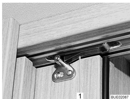
Bild 17 Spärr med fjäder
