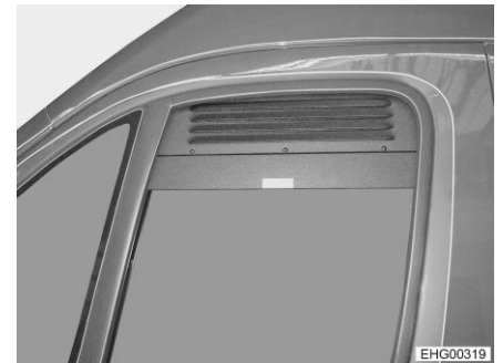
Bild 62 Ventilationsgaller (sidofönster stängt)
