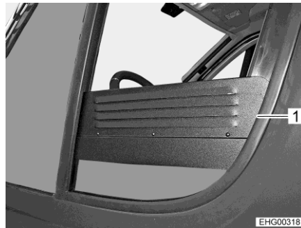
Bild 61 Ventilationsgaller (sidofönster öppet)
