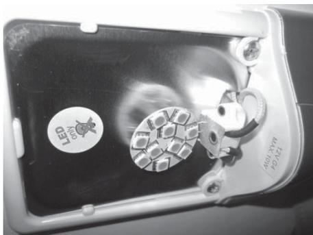
Fig. 215: Replacing LEDs
