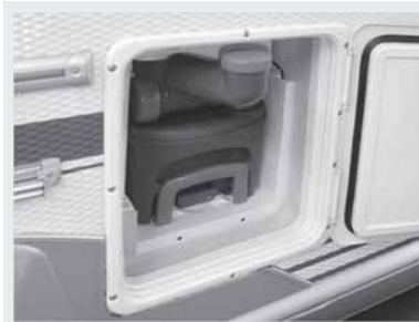
Fig. 46: Kloakktank med påfyllingsstuss for spylevann
