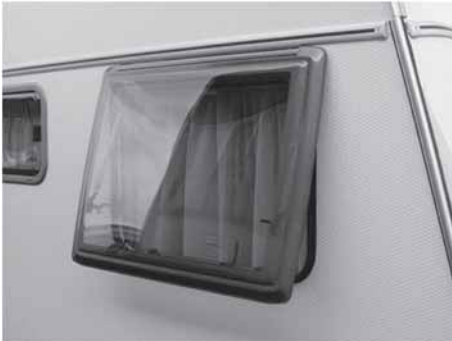
Fig. 22: Vindu som åpnes utover, med ramme
