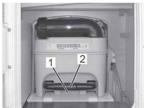
Fig. 193: Kloakktank i avfallsjakten
