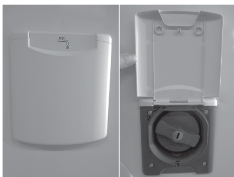
Fig. 90: Påfyllingsstuss for ferskvann
