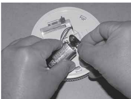
Fig. 217: Skift ut batteriet
