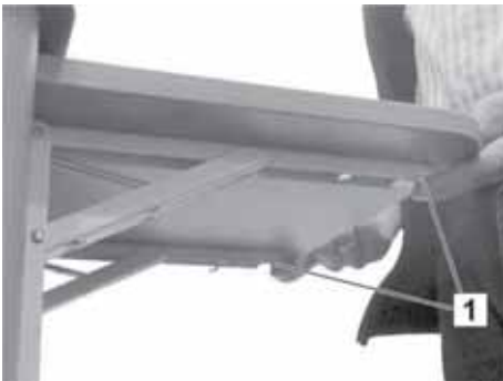
Fig. 201: Løsne låsemekanismen på vippekonsollen
