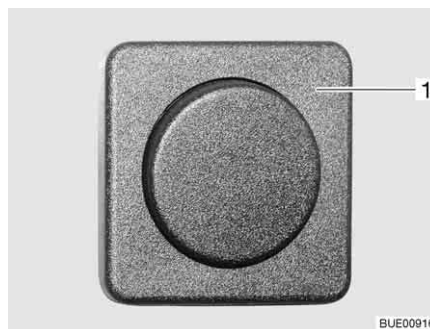
Fig. 48 Éclairage intérieur, interrupteur d'éclairage séparément de la lampe
