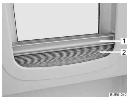
Fig. 31 Dispositif occultant plissé
