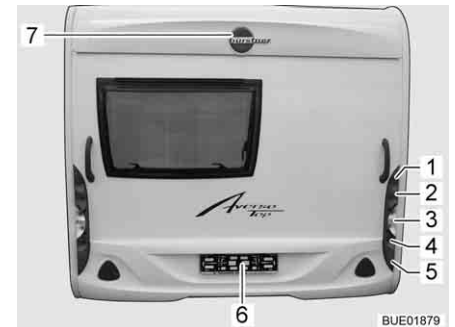
Fig. 218 Eclairage arrière (alternative)
