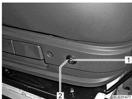
Fig. 19 Interrupteur du chauffage de siège
