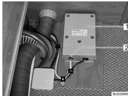
Fig. 147 Transformateur du chauffage électrique du plancher
