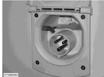
Fig. 123 Raccordement 230 V sur le véhicule
