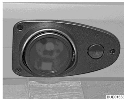
Fig. 193 Lampe DEL avec interrupteur
