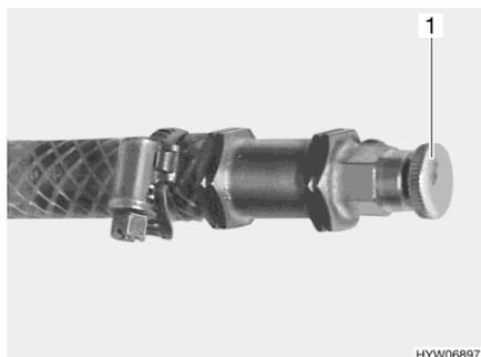
Fig. 187 Soupape de purge pour le chauffage à eau chaude
