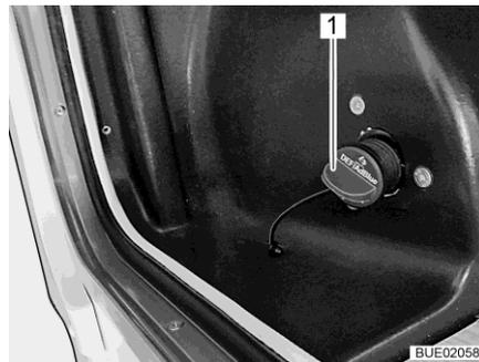
Fig. 25 Bec de remplissage d'AdBlue®
