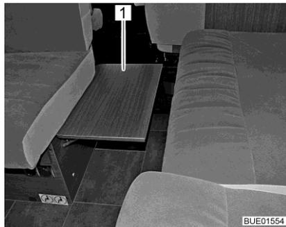
Fig. 100 Élargissement du siège repliable
