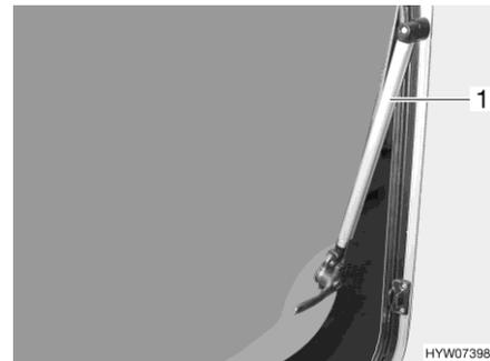
Fig. 71 Fenêtre projetante avec bras automatique
