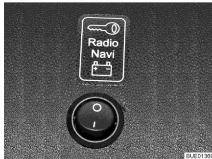
Fig. 118 Commutateur/sélecteur pour l'alimentation en courant
