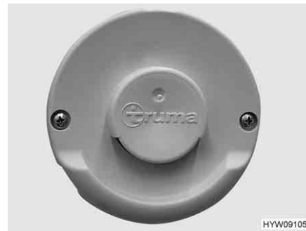
Bild 209 Wandkamin der Warmluft-Heizung
