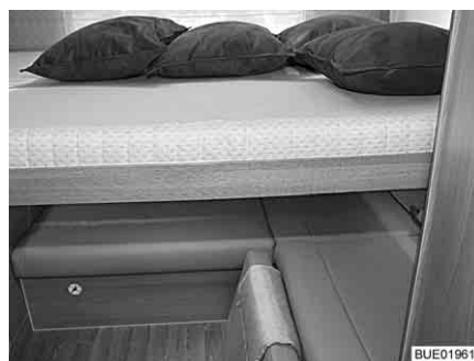
Bild 135 Hubbett Heck, abgesenkt
