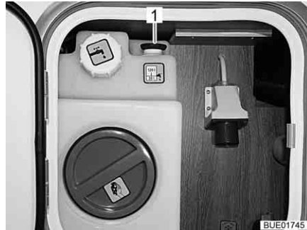
Bild 248 Wassertank (zentrale Versorgungseinheit)
