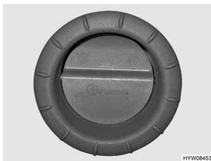
Bild 194 Luftaustrittsdüse der Warmluft-Heizung
