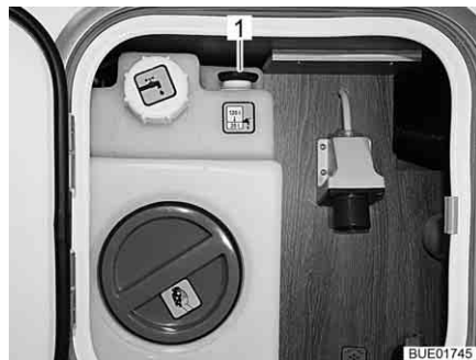
Bild 249 Wassertank (zentrale Versorgungseinheit)
