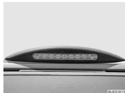
Fig. 65 Eclairage de l'auvent
