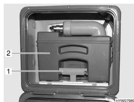
Fig. 257 Réservoir pour matières fécales (exemple)
