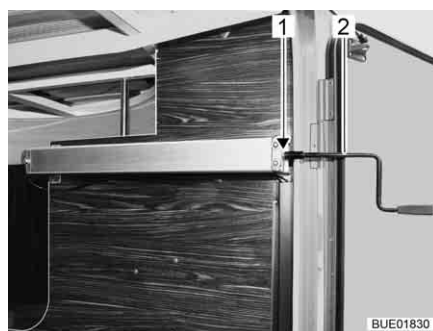
Fig. 120 Manivelle dans le garage arrière
