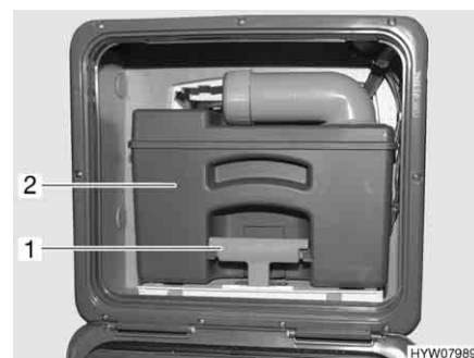
Fig. 257 Depósito de aguas fecales (ejemplo)
