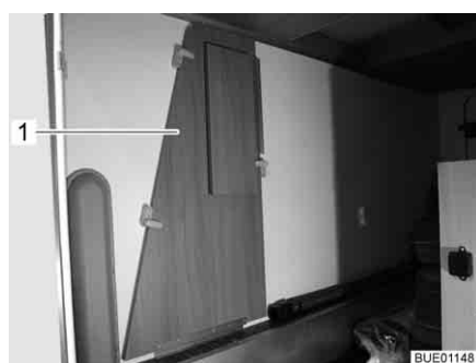
Fig. 15 Ensanchamiento de cama en el garaje trasero
