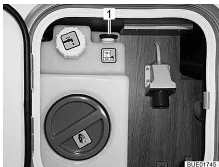
Fig. 246 Depósito de agua (unidad de alimentación centralizada)
