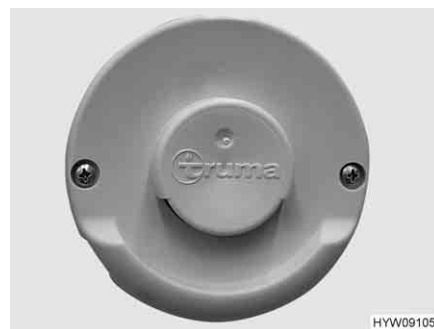
Fig. 207 Tubo de chimenea en la pared de la calefacción de aire caliente
