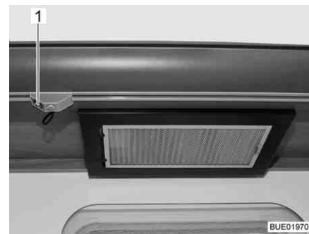
Fig. 223 Campana sin ventilación
