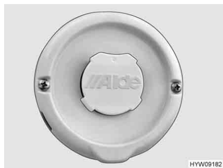
Fig. 206 Tubo de chimenea en la pared de la calefacción de agua caliente
