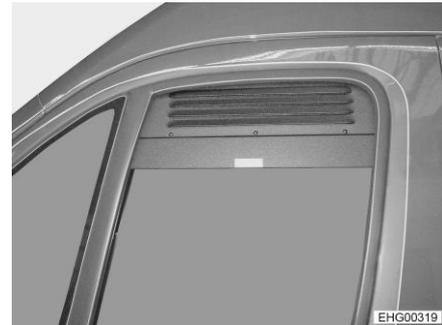
Fig. 79 Grille d'aération forcée (fenêtre latérale fermée)
