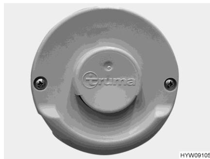
Fig. 110 Cheminée murale (chauffage à air chaud)
