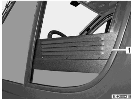
Fig. 78 Grille d'aération forcée (fenêtre latérale ouverte)
