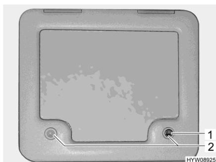
Fig. 133 Portillon pour le réservoir pour matières fécales
