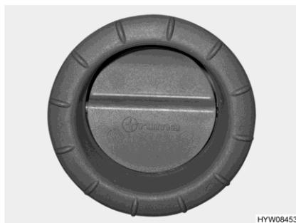
Fig. 104 Buse de sortie d'air (chauffage à air chaud)
