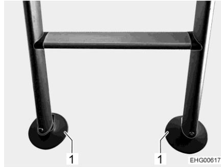
Fig. 84 Pieds en plastique sur l'échelle de montée
