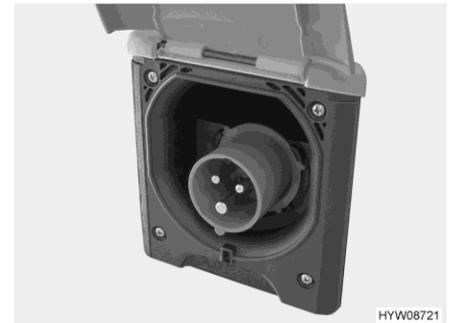
Fig. 98 Raccordement 230 V sur le véhicule (prise de courant CEE)
