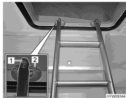
Fig. 83 Échelle de montée (accrochée)
