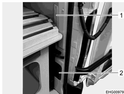
Fig. 138 Accès à la fixation de l'unité de feux arrière (Delfin C)
