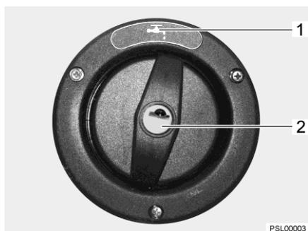
Fig. 120 Couvercle de fermeture pour bec de remplissage d'eau potable
