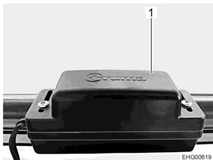
Fig. 112 Interrupteur de contact de fenêtre
