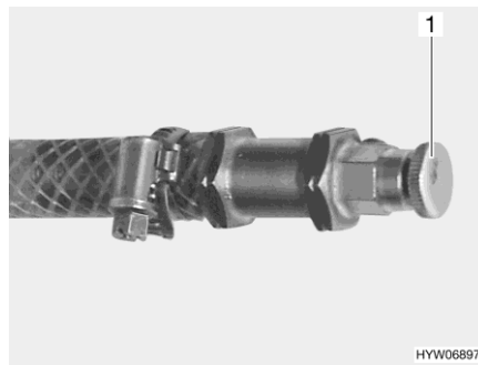
Fig. 160 Soupape de purge pour le chauffage à eau chaude
