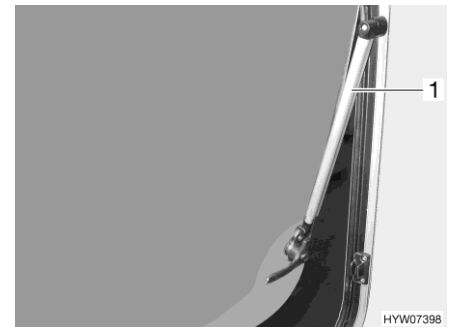
Fig. 80 Fenêtre projetante avec bras automatique
