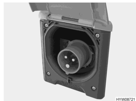
Fig. 114 Raccordement 230 V sur le véhicule (prise de courant CEE)
