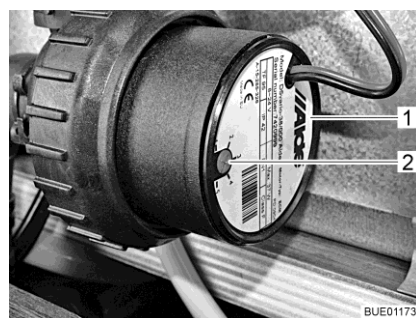
Fig. 131 Réduction de la vitesse de rotation
