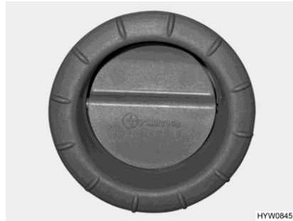
Fig. 140 Buse de sortie d'air (chauffage à air chaud)
