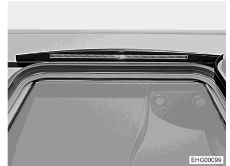
Fig. 57 Éclairage de l'auvent
