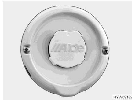
Fig. 152 Cheminée murale (chauffage à eau chaude)
