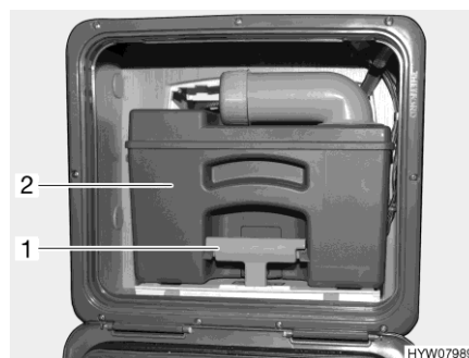
Fig. 194 Réservoir pour matières fécales
