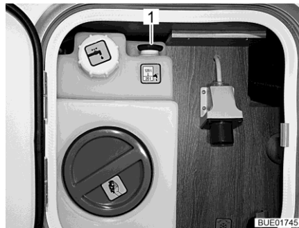
Fig. 175 Réservoir d'eau (unité de service)
