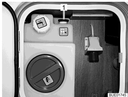
Fig. 177 Réservoir d'eau (unité de service)
