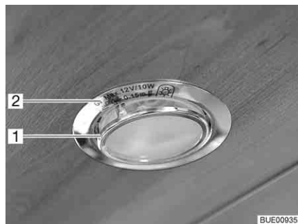
Fig. 218 Lampe halogène encastrée (plate)
