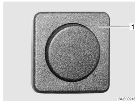
Fig. 43 Éclairage intérieur, interrupteur d'éclairage séparément de la lampe
