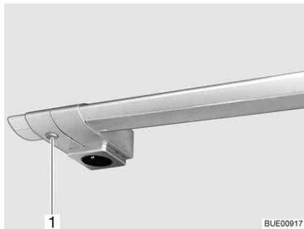
Fig. 42 Éclairage intérieur, interrupteur d'éclairage directement sur la lampe
