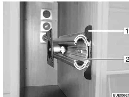
Fig. 49 Support dans le meuble de télévision
