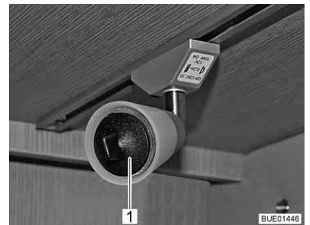
Fig. 225 Ventouse pour changement de lampe
