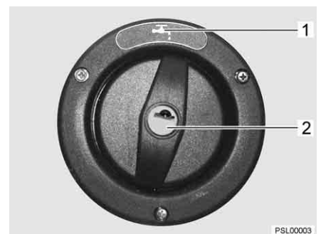
Fig. 164 Bec de remplissage d'eau potable (alternative)
