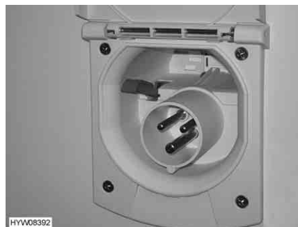
Fig. 110 Raccordement 230 V sur le véhicule
