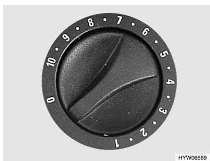
Fig. 123 Bouton tournant du chauffage
