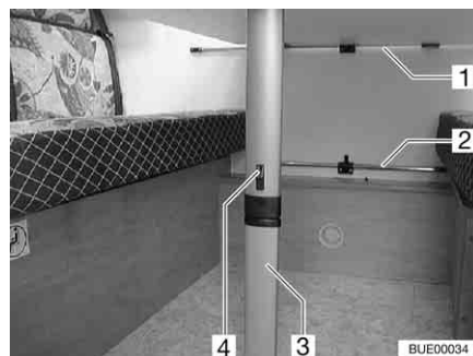
Fig. 69 Table suspendue à pied articulé
