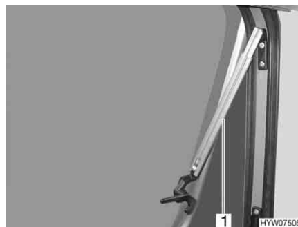
Fig. 56 Fenêtre projetante avec bras automatiques, ouverte
