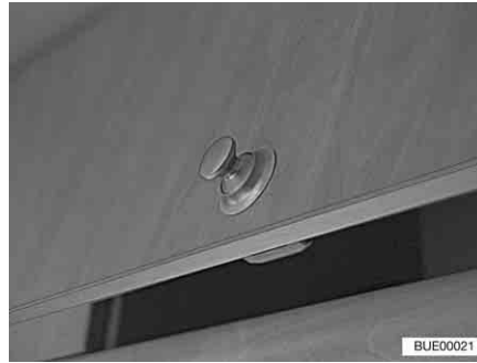
Fig. 35 Abattant de placard avec bouton-poussoir
