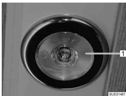
Fig. 44 Lampe encastrée, interrupteur d'éclairage dans la lampe
