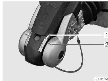
Fig. 4 Contrôle "AKS terminé"
