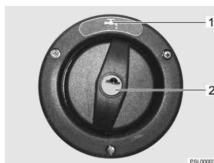
Fig. 35 Couvercle de fermeture pour bec de remplissage d'eau potable (alternative)
