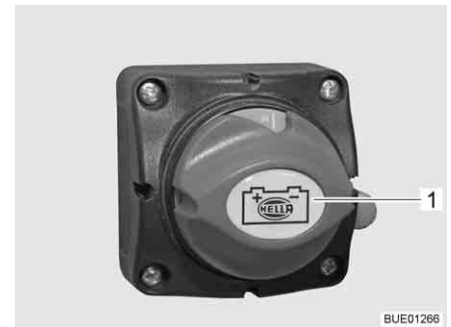
Fig. 89 Interrupteur principal des batteries, position "ON"
