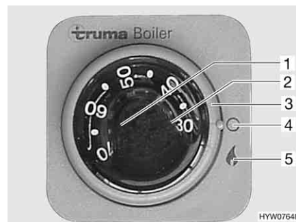
Fig. 126 Unité de commande pour le chauffe-eau Truma (régime au gaz)
