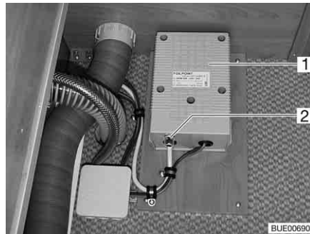
Fig. 132 Transformateur du chauffage électrique du plancher
