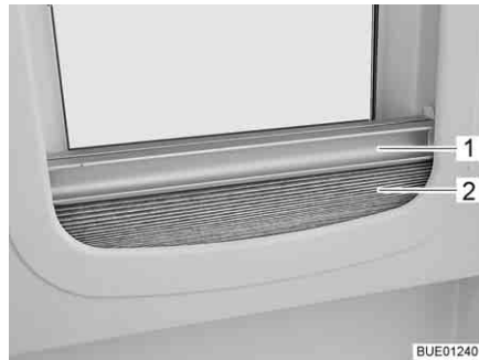
Fig. 25 Dispositif occultant plissé
