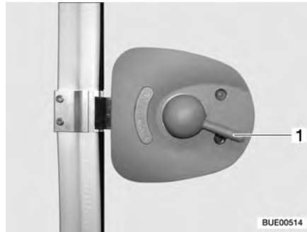
Fig. 24 Serrure de la porte cellule, à l'intérieur, ouverte
