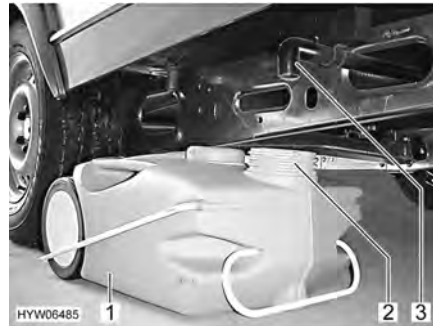
Fig. 21 Réservoir d'eaux usées, mobile
