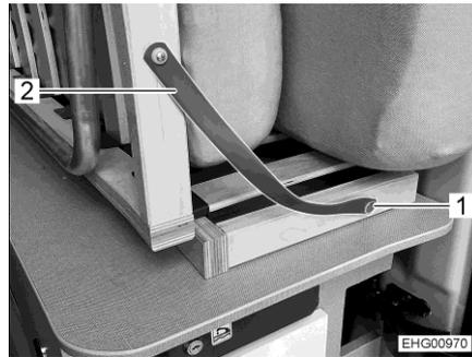
Fig. 70 Cinta de sujeción en el somier derecho
