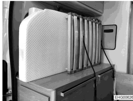
Fig. 55 Cama transversal (posición de transporte) (Campeo C 540, C 600)
