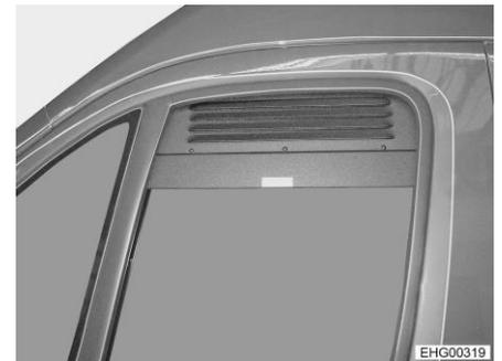
Fig. 79 Rejilla de ventilación forzada (ventana lateral cerrada)
