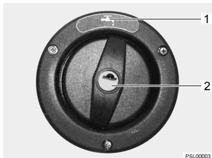
Fig. 120 Tapa de cierre para el tubo de llenado de agua potable
