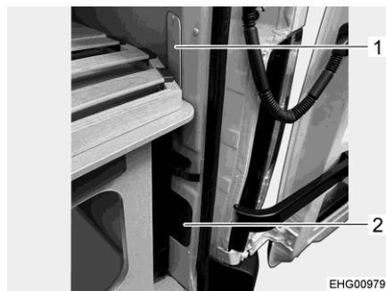
Fig. 138 Acceso a la unidad de luces traseras (Delfin C)
