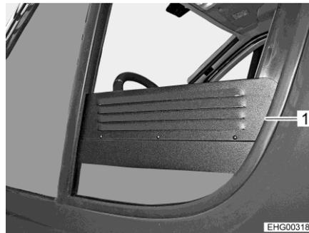
Fig. 78 Rejilla de ventilación forzada (ventana lateral abierta)
