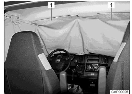
Fig. 23 Oscurecedor de la cabina del conductor en la luna delantera
