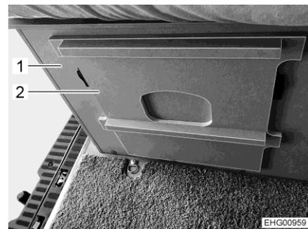
Fig. 7 Panel separador en la caja de almacenamiento (Delfin C)
