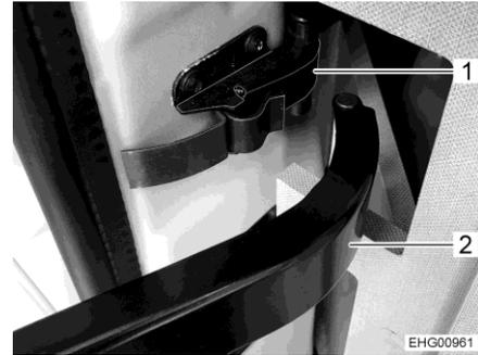
Fig. 16 Palanca limitadora (Delfin C)
