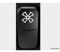
Fig. 136 Auxiliary fan rocker switch
