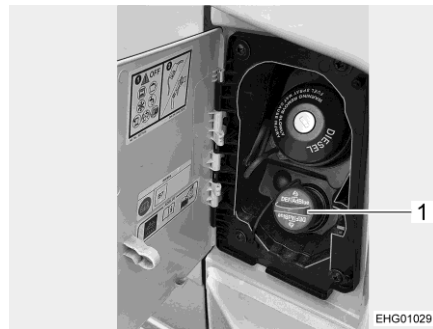
Bild 35 Einfüllstutzen für AdBlue®
