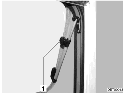
Bild 95 Dachhaube mit Dreh-Ausstellern, geöffnet
