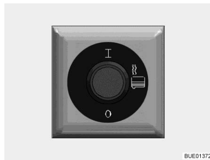
Kuva 150 Kytkin jäteveden lämmitykselle
