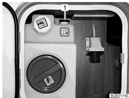
Fig. 277 Serbatoio dell'acqua (unità di servizio)
