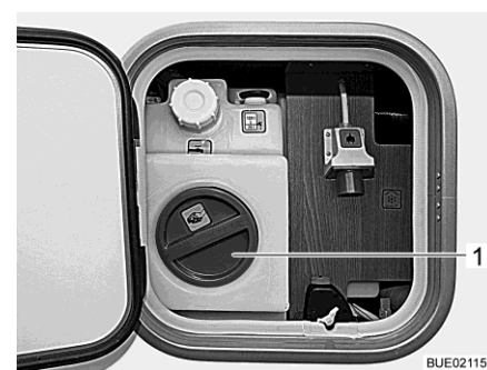
Fig. 307 Apertura per la pulizia sul serbatoio dell'acqua (unità di servizio)
