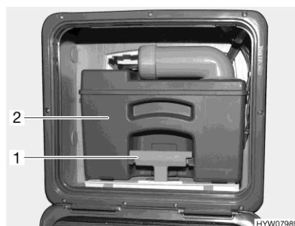
Fig. 304 Serbatoio fecale (esempio)
