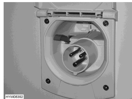
Fig. 208 Collegamento a 230 V al veicolo (senza unità di servizio)
