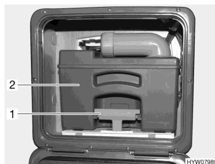
Fig. 292 Serbatoio fecale (esempio)
